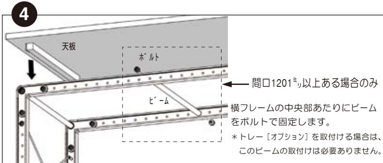
・プレスの取付けは、設計上フレームとの間に1、2ミリ程度の間隙がきますので、完全にボルトを締めなくても補強の機能を果たします。
